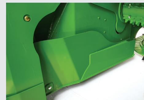
As sapatas laterais flutuantes, possui ponto de articulação vinculado ao chassi, isso mantém a altura adequada, para reduzir perdas e riscos de quebra durante a operação e manobras.
