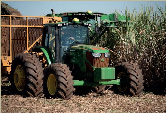
Tratores: De 60 a 400cv de produção nacional e versões canavieiras na faixa de 200cv com eixo de 3 metros, Field Cruise, pino-bola e piloto Autotrak integrado.
