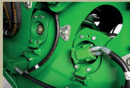
Fácil acesso ao sistema de alimentação, com rolamentos externos e batedores aparafusados em borracha.
