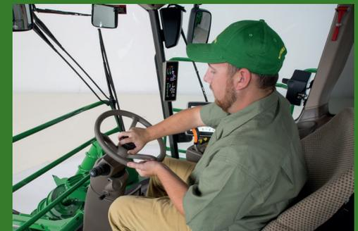
O banco, com suspensão a ar, possui múltiplos ajustes e é giratório e a coluna de direção possui inclinação dupla, tudo para que o operador possa ajustar a posição de trabalho de acordo com a sua preferência.
