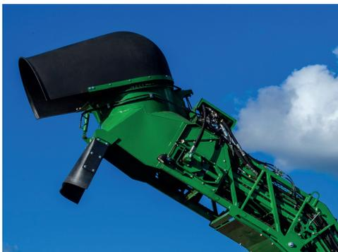
O extrator secundário completa a limpeza, e a sua rotação do capô, de 360 graus, direciona a palha para fora do transbordo, na direção desejada.
