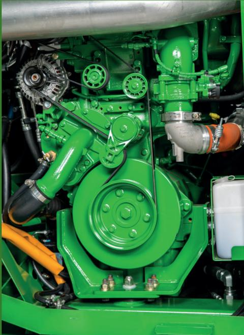
As colhedoras CH570 e CH670 estão equipadas com o eficiente motor agrícola John Deere PowerTech 9,0L que atende a normas de emissões MARI. Alta conversão energética contam com potências nominais de 342cv na CH570 e 380cv na CH670. Mas se as condições de campo exigirem mais, os motores contam com uma reserva de potencia de 10%, visando manter o desempenho da colheita.
