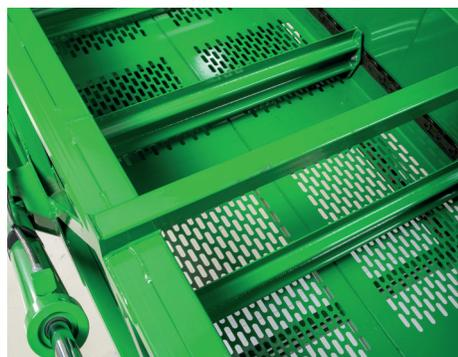
As paredes laterais altas e as taliscas reversíveis evitam a queda de toletes. O piso perfurado proporciona melhor remoção de impurezas.
