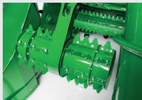
O ajuste hidráulico sincronizado mantém o contato simultaneamente dos rolos com a cana, melhorando a alimentação e minimizando a quebra, principalmente em variedades mais frágeis.
