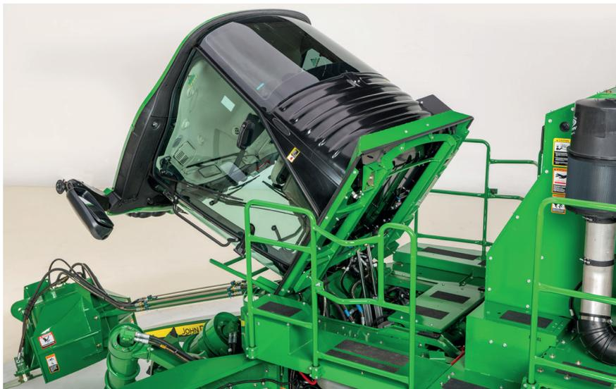
Fácil acesso para a execução das operações de serviço na CH570 e da CH670, facilitam manutenções e inspeções, resultando em alta disponibilidade. Escadas e corrimões, localizados em ambos os lados da máquina permitem o acesso rápido à parte superior da cabine.
