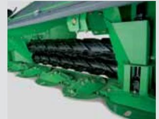
O exclusivo sistema John Deere, com cubos de proteção, oferece mais segurança aos componentes internos. Seu desenho absorve o impacto de qualquer material estranho, protegendo as engrenagens da transmissão.
